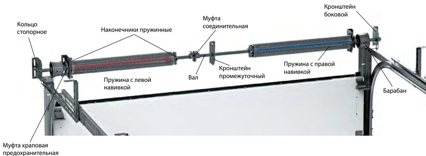
ДВУХВАЛЬНАЯ СИСТЕМА БАЛАНСИРОВКИ ПОЛОТНА ПРОМЫШЛЕННЫХ ВОРОТ
