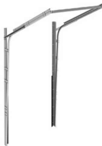
Наклонный высокий монтаж с верхним расположением вала
